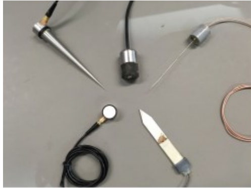
Fig. 1. Различни тестове акустични сензори в WSL, Бирменсдорф / Швейцария.
