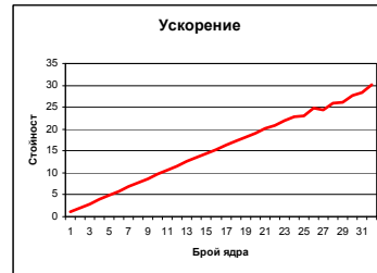
Фиг. 4.4 Ускорение при стеганализ с различен брой процесори
