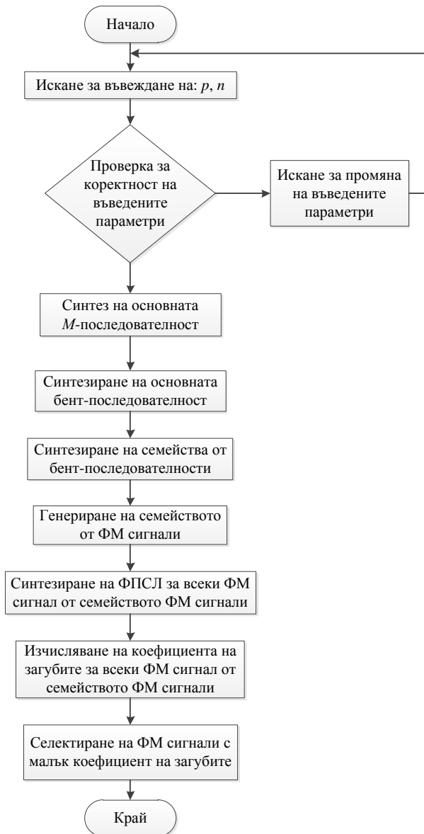
Фиг. 1: Блок-схема на универсална програмата, реализираща Алгоритъм 1.
